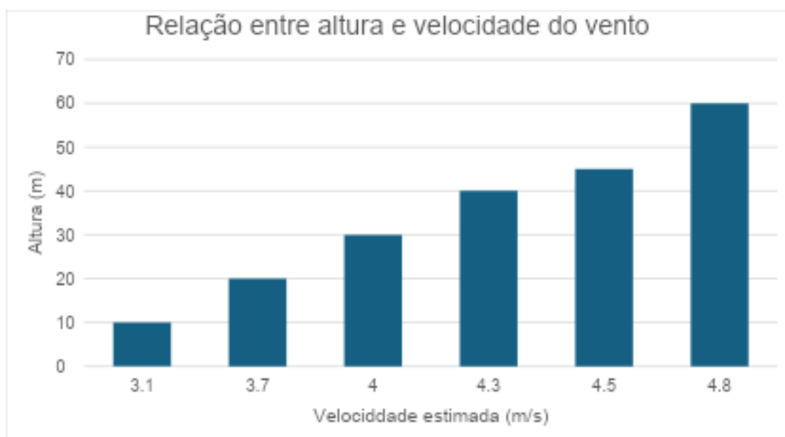
Figura 4 – Perfil vertical de velocidade do vento – extrapolação logarítmica a partir dos dados do SBIL..
