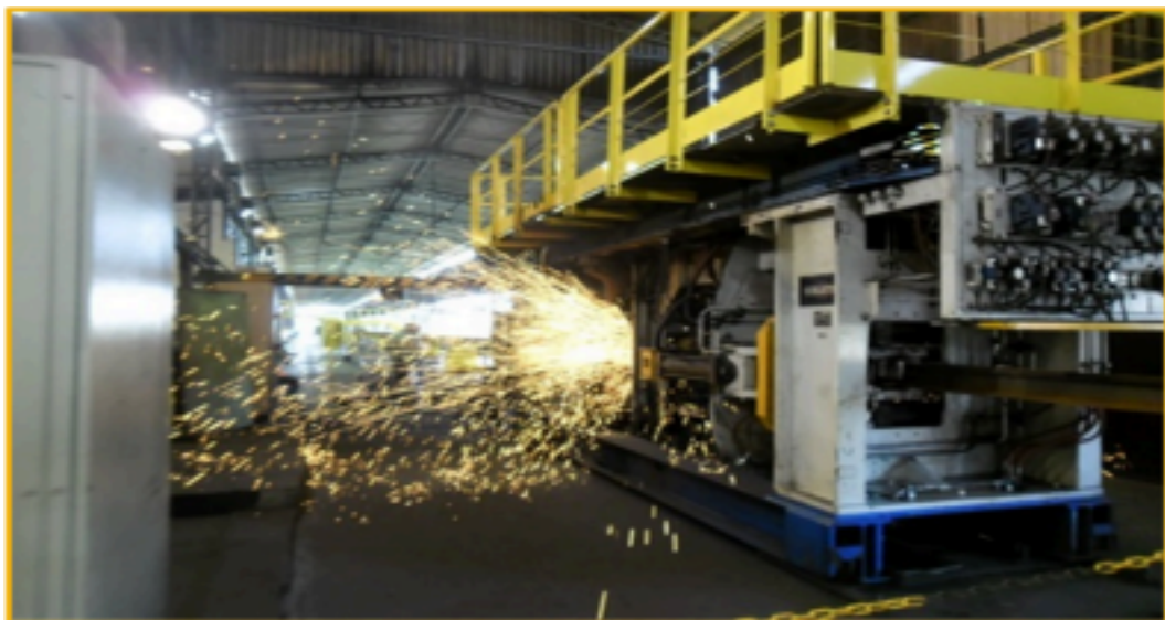
Figura 8 - Soldagem de trilhos pelo processo flash boot .
