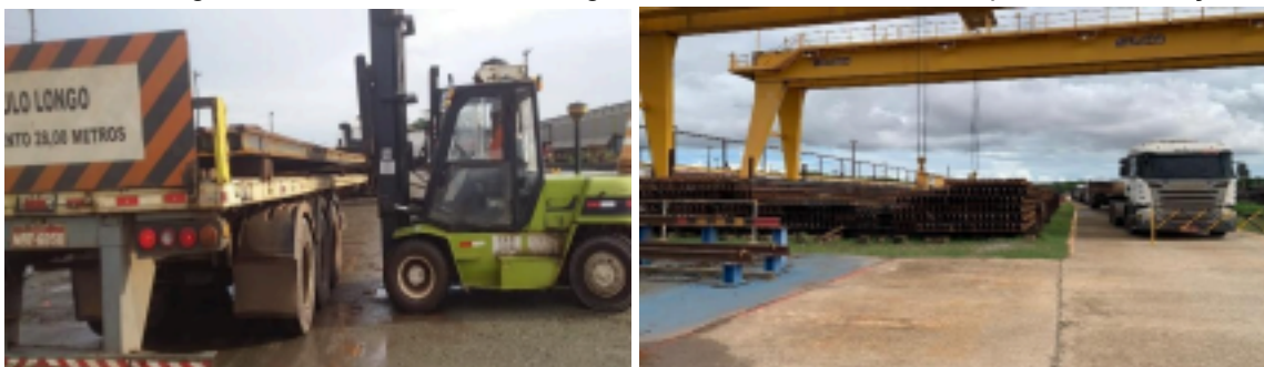
Figura 10 – Processo de descarga de trilhos curtos, antes e depois da automação
