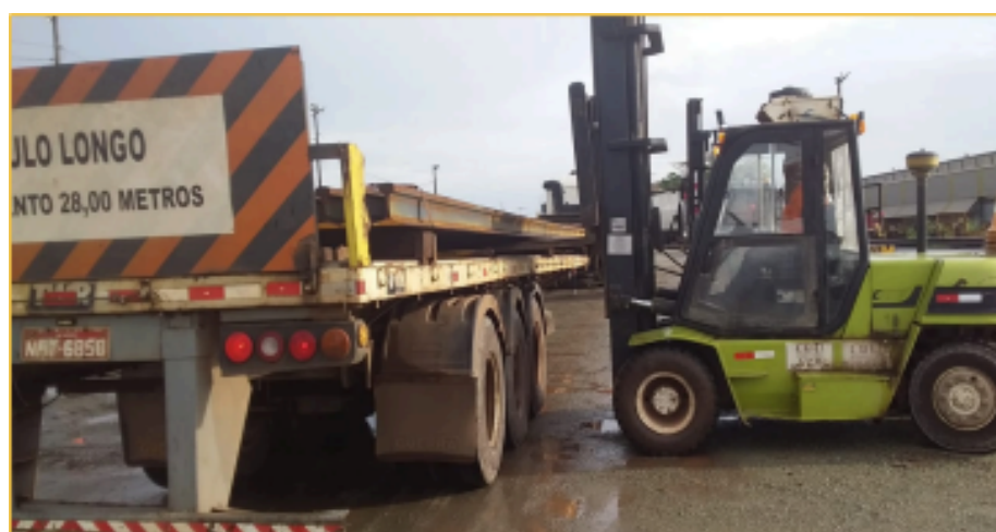
Figura 6 - Processo de recebimento e estocagem de trilhos curtos com empilhadeiras
