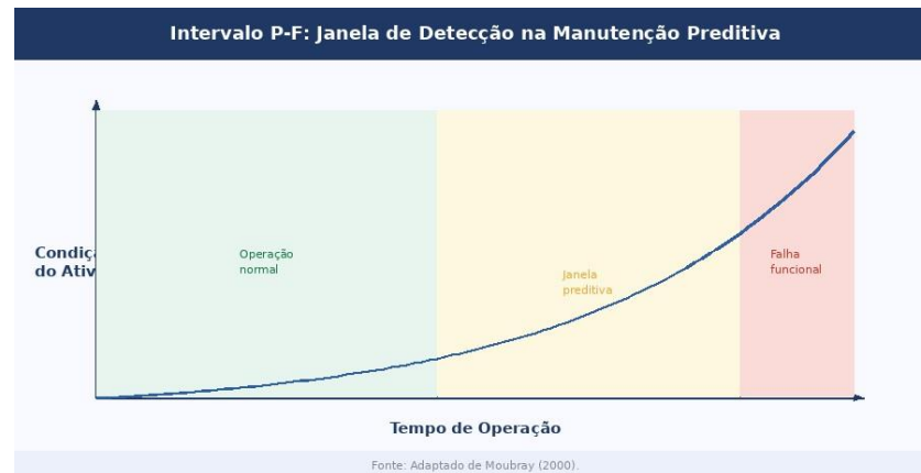
Figura 7 – Intervalo P-F: janela de detecção na manutenção preditiva
