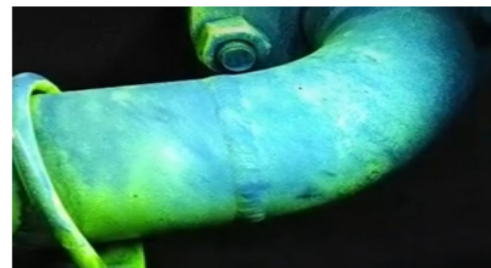
Figura 5 - Inspeção visual final e registro das descontinuidades
