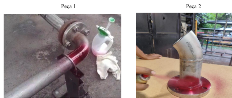
Figura 2 - Aplicação do líquido penetrante e infiltração nas discontinuidades
