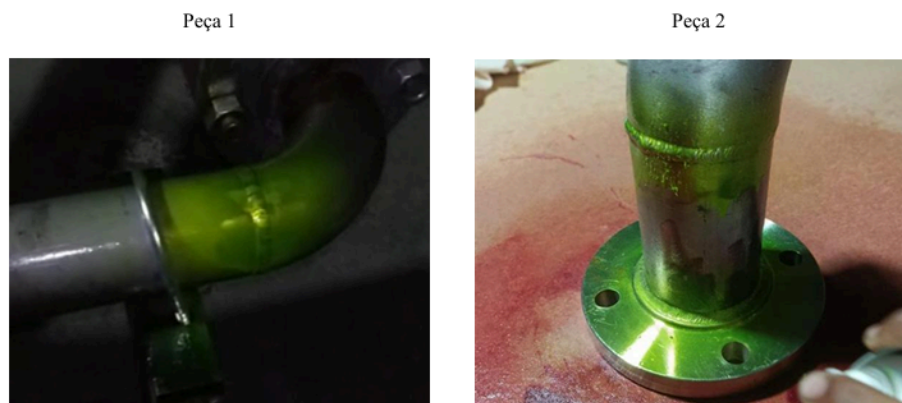
Figura 4 - Aplicação do revelador e aparecimento das indicações
