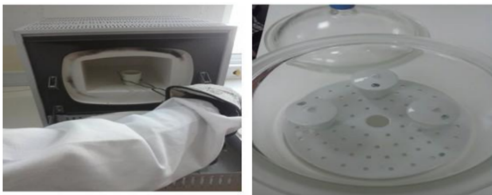
Figura 7 – Cadinho colocado na mufla a 775°C (à esquerda), e arrefecimento no dessecador (à direita) (Fonte: Elaboração Propria, 2026).
