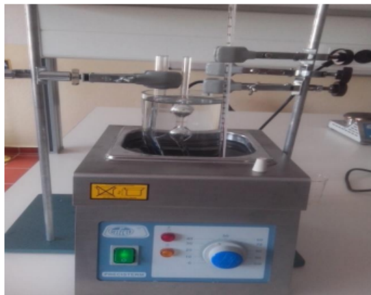
Figura 9 - Ensaio de viscosidade cinemática, ASTM D 445 (Fonte: Elaboração Propria, 2026).
