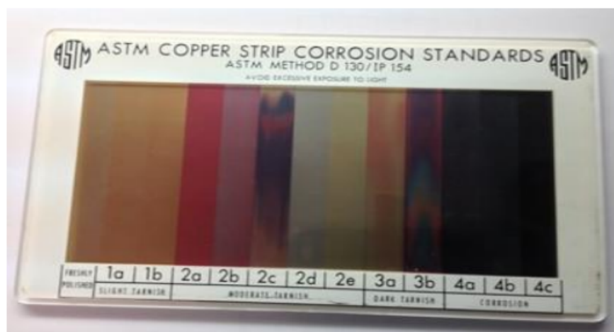
Figura 11 – Classificação da coloração ASTM padrão das lâminas de cobre (Fonte: Elaboração Propria, 2026).
