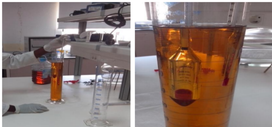
Figura 3 – Realização do ensaio de massa volúmica, ASTM D 4050 (Fonte: Elaboração Própria, 2026).
