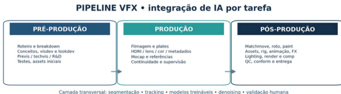
Figura 1 — Macroetapas de um pipeline de VFX e pontos transversais de apoio por IA/ML. Fonte: elaboração gráfica do autor para este artigo; síntese conceitual baseada em [10–12].
