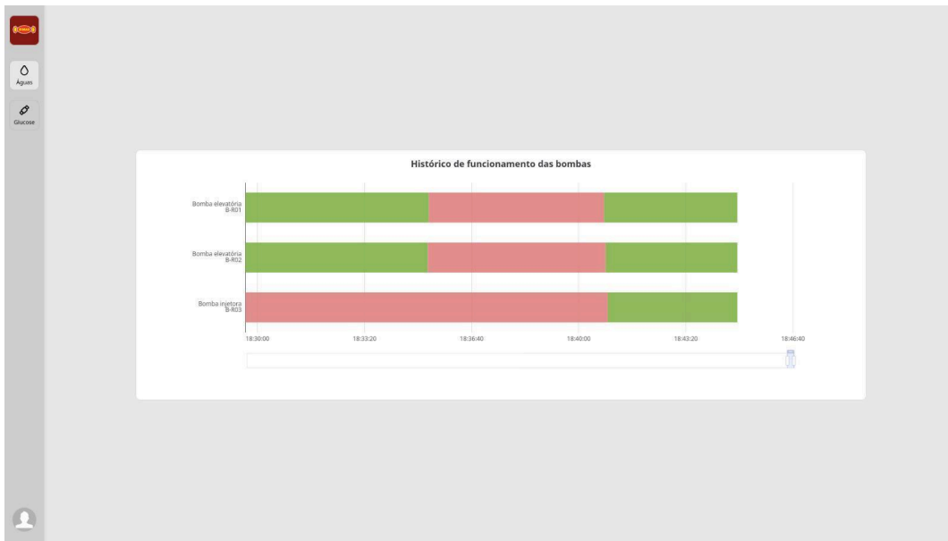
Figura 10 - Tela de gráficos de funcionamento das bombas
