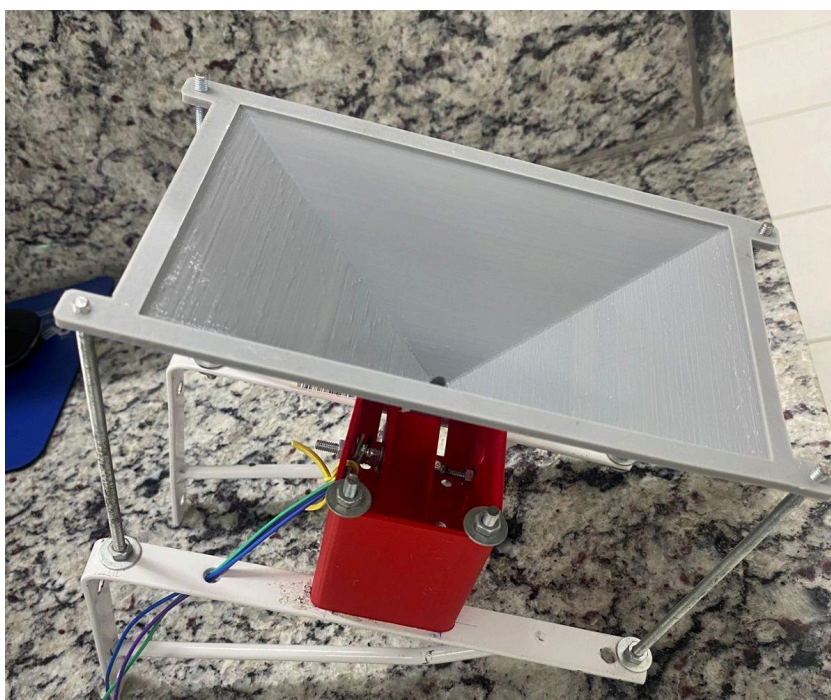
Figura 5 - Pluviômetro do tipo tipping bucket desenvolvido no projeto
