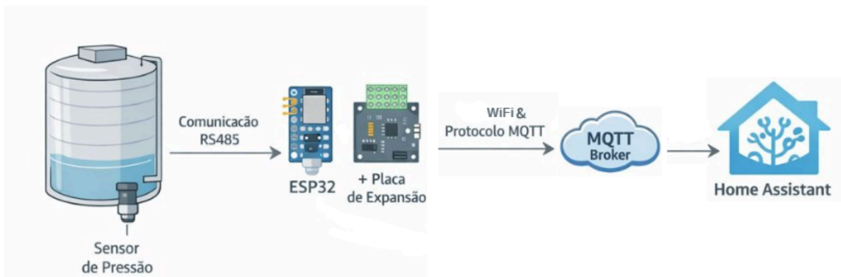
Figura 4 - Diagrama da arquitetura de comunicação dos sensores de pressão
