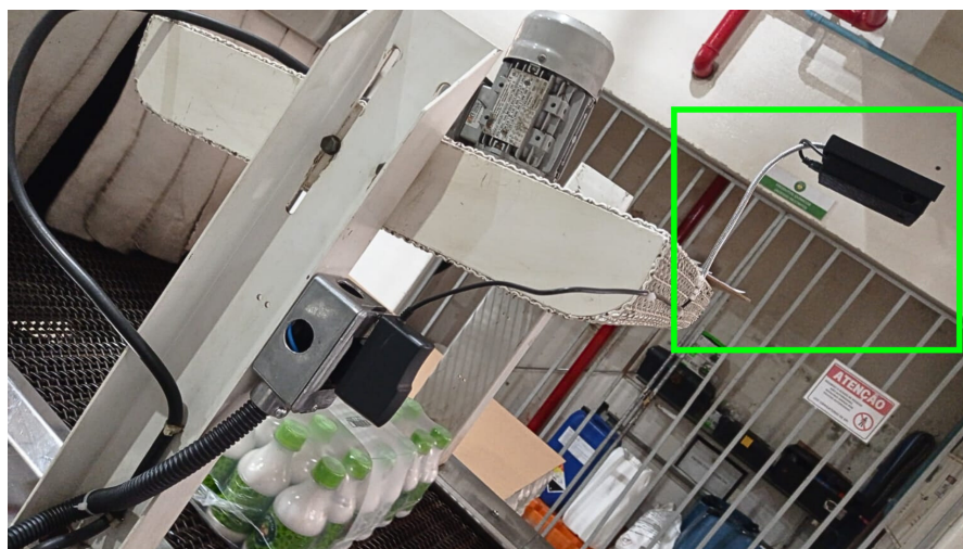
Figura 3 - Hardware de coleta de imagens de fardos de garrafas de leite de coco.
