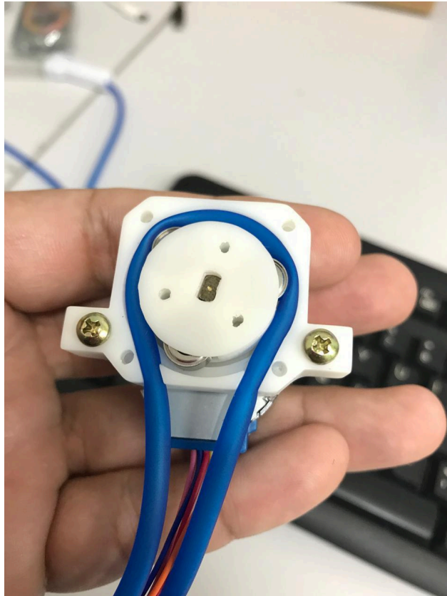
Figura 7 - Modelo de bomba peristáltica com equipo padrão em PVC.
